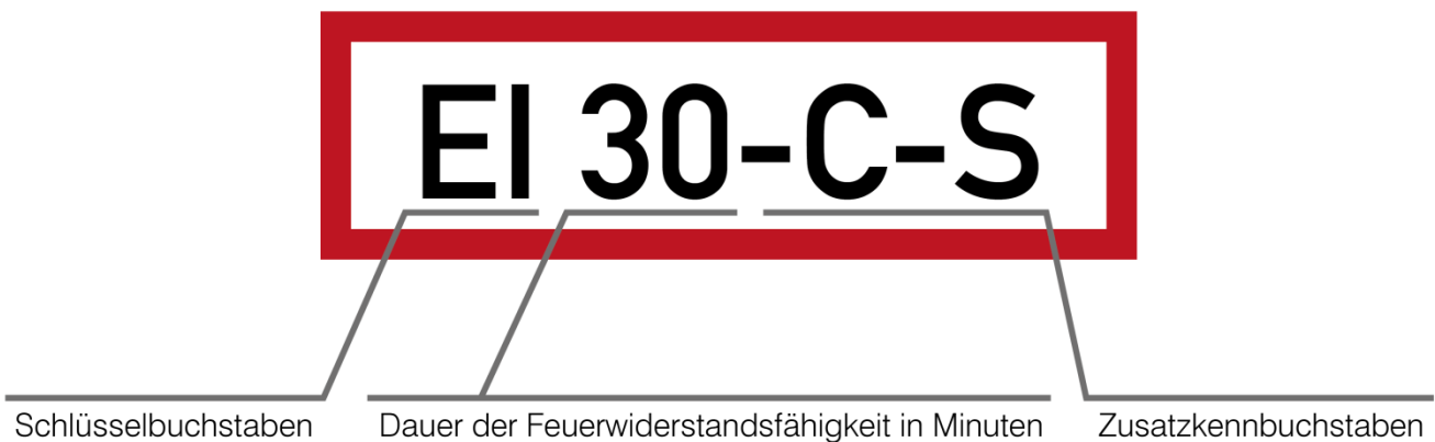
Abb. 16: Beispielhafte Benennung einer feuerhemmenden, selbstschließenden Tür mit Rauchdichtheit nach /DIN EN 13501-2/
