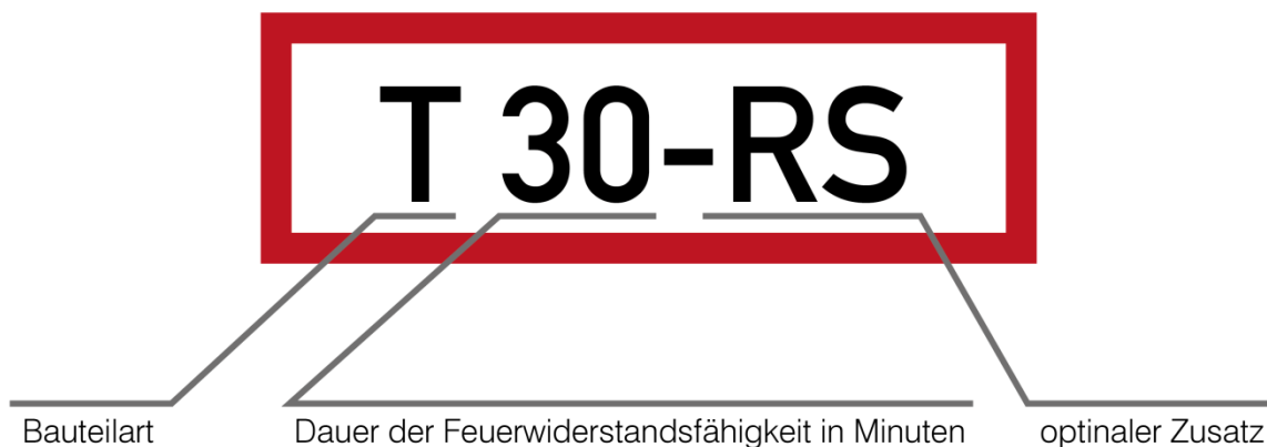
Abb. 15: Beispielhafte Benennung einer feuerhemmenden Tür nach /DIN 4102-5/ mit zusätzlicher Rauchschutzfunktion nach /DIN 18095-1/
