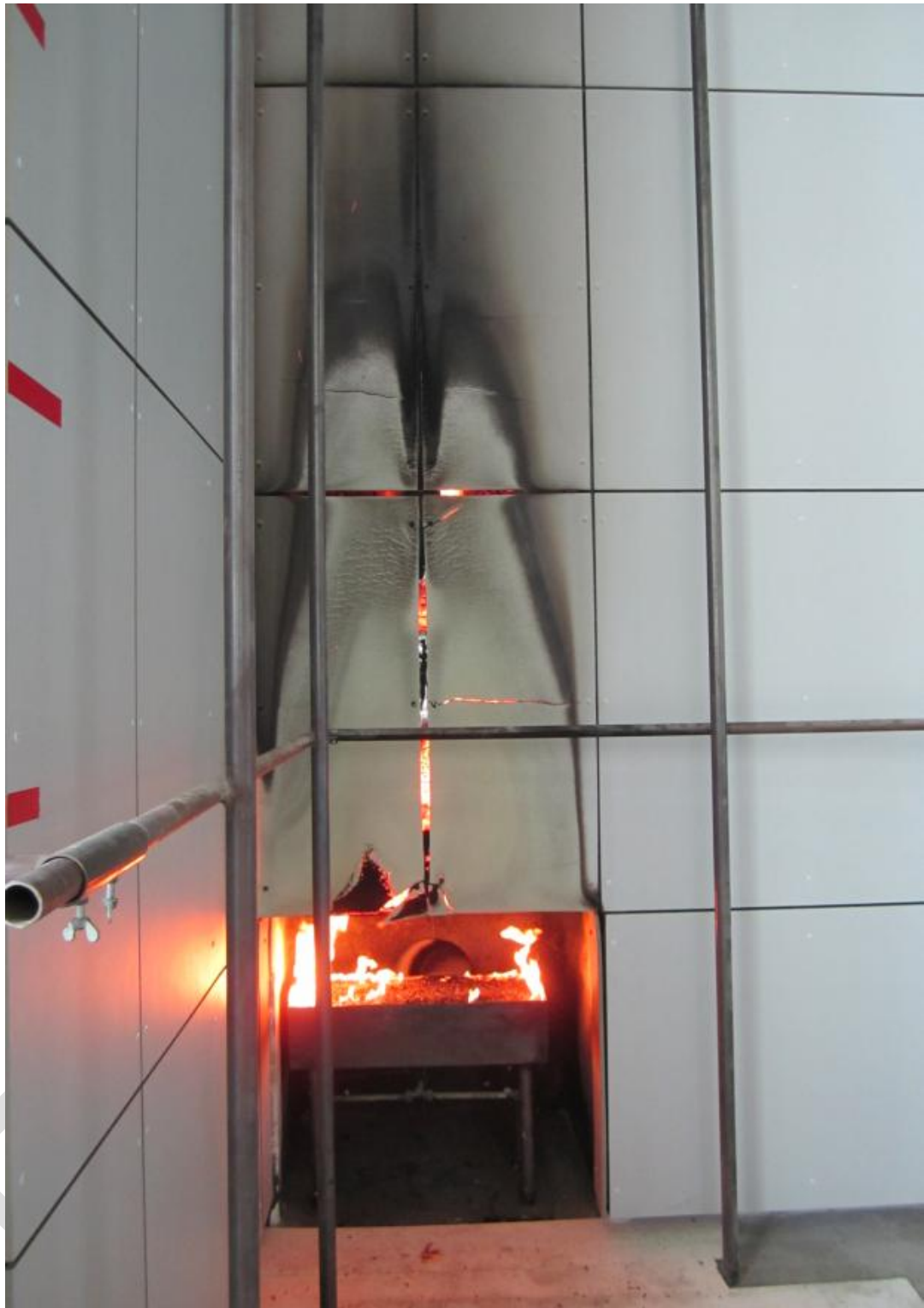
Bild 3 Fassade nach Versuchsende (Abstellen des Brenners)
