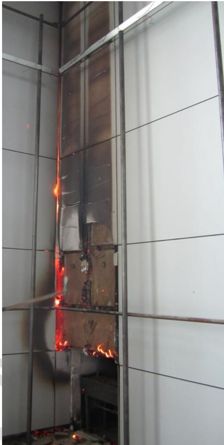
Bild 4 Fassade nach Versuchsende (nach Herabnahme der unteren Platten), beim Löschvorgang
