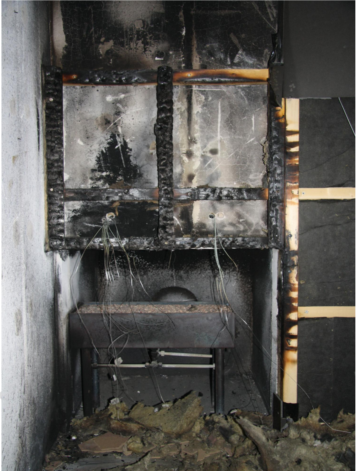
Foto 2 Unterkonstruktion Fassade nach Versuchsende, Darstellung des Feldes E1 oberhalb des Brenners
