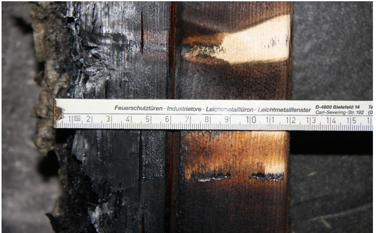
Foto 3 Unterkonstruktion Fassade nach Versuchsende, Detaildarstellung des Feldes E1 oberhalb des Brenners im Anschluss zur rechtsliegenden Fassadenunterkonstruktion
