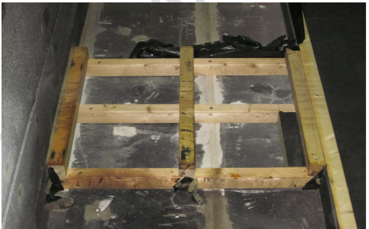
Foto 4 Unterkonstruktion Fassade nach Versuchsende, Darstellung des Feldes E2
