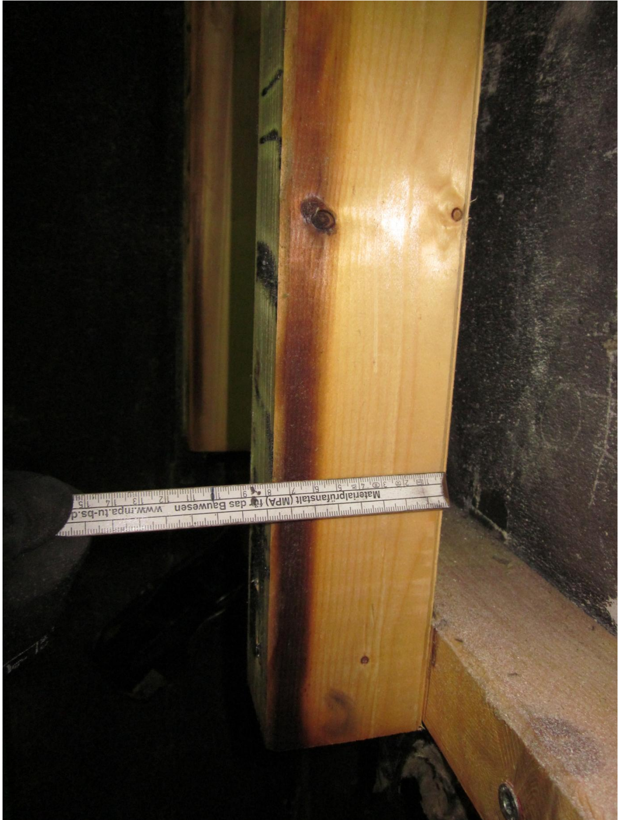
Foto 5 Unterkonstruktion Fassade nach Versuchsende, Detaildarstellung des Feldes E2, Mittelposten der Konterlattung im unteren Bereich des Feldes
